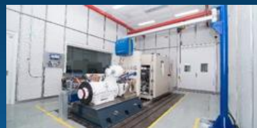
165 KW motor test stand
